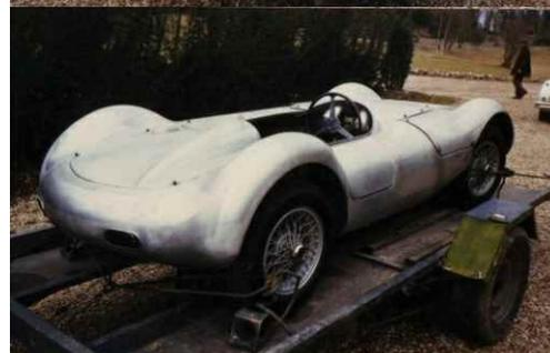
L'assemblage de la nouvelle carrosserie sur le châssis.
